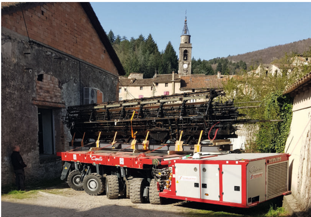
Einbringen einer Lieberknecht-Maschinen-Hälfte durch das Hallentor, im Hintergrund der Kirchturm von Sumène
