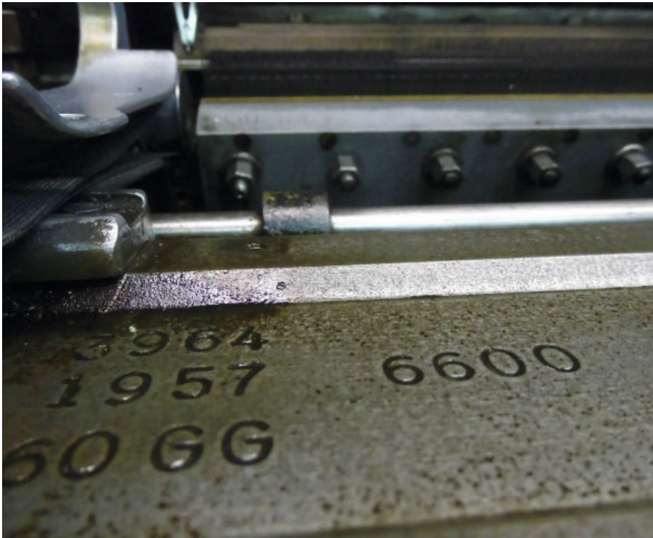
Kennzeichnung auf dem Maschinenbett: Baujahr 1957 und Feinheit 60 GG
