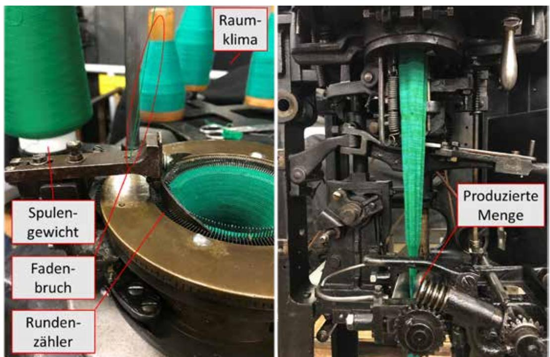
*Zu ermittelnde Größen an der Rundstrickmaschine: Raumklima, Spulengewicht, Fadenbruch, Rundenzähler sowie produzierte Menge*
