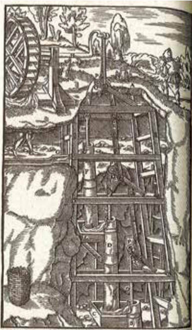
Die Ehrenfriedersdorfer Radpumpe, abgebildet in der „De re metallica“
