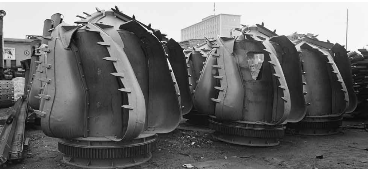
Bohrköpfe für die Montage an Großbaumaschinen, VEB Schwermaschinen „S. M. Kirow“, Leipzig, 1959
