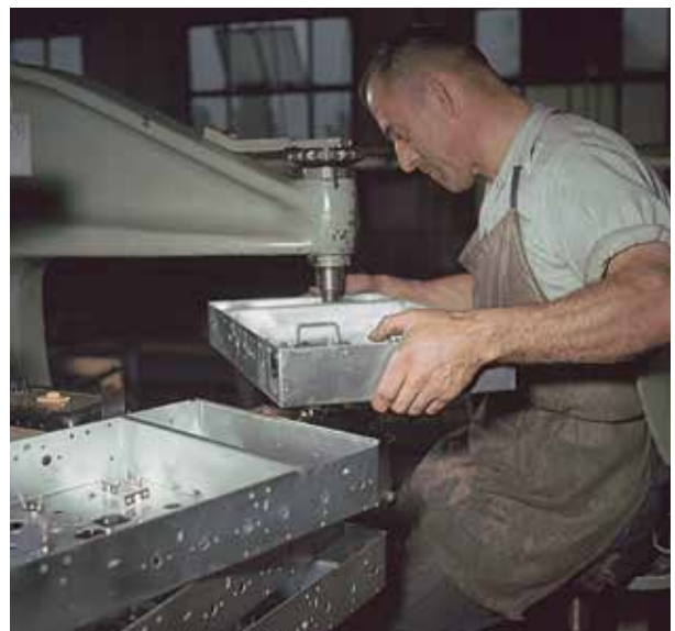
Arbeiter vernietet/bohrt Rahmen, VEB Sachsenwerk Radeberg, 1954
