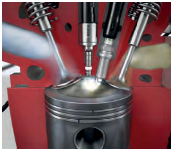
Ottomotor mit Flammenfront durch Fremdzündung (links) und Dieselmotor mit gleichzeitiger Verbrennung durch Selbstzündung (rechts) – moderne Ausführungen mit Kraftstoffdirekteinspritzung in den Brennraum
