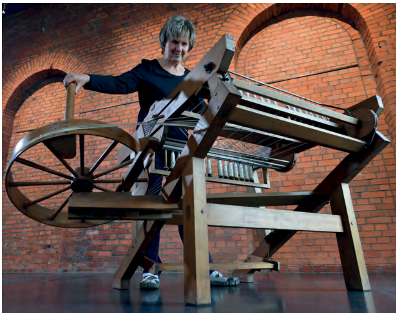
Im Vergleich zur Handspindel und zum Spinnrad sind die Hände bei der Spinning Jenny aus dem Spinnprozess selbst völlig herausgelöst und bedienen nur noch die Maschine.
