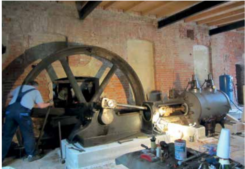
Probelauf der Dampfmaschine
