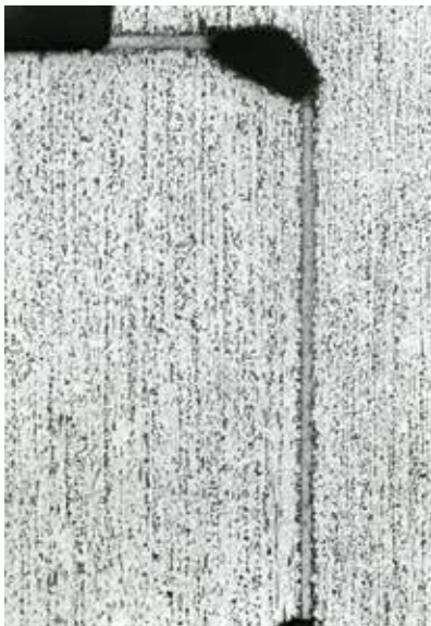
Bruchstelle der Lötnaht an einer normalen Hartlötverbindung.
