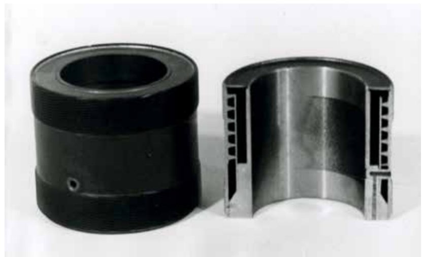
Heizkörper für eine Heistreckzwirnmachine, Ofenlötung unter Schutzgas.
