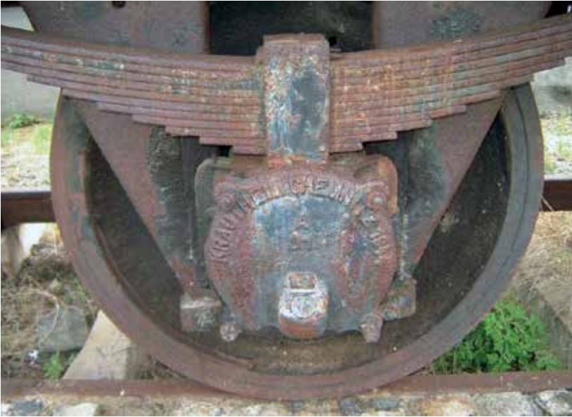
Achslagergehäuse im eingebauten Zustand mit der Aufschrift „Krautheim Chemnitz 1944“.
