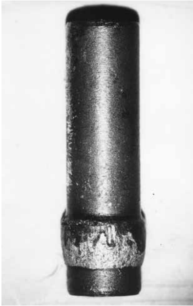
Bruchstelle einer hochfesten Hartlötverbindung im Grundwerkstoff
