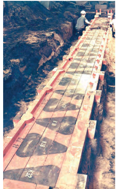
Einformen eines 32 m langen Werkzeugmaschinenbettes für die Maschinenfabrik in Meuselwitz.
