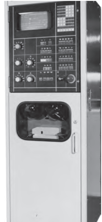
1978: CNC600, Mikroprozessorsteuerung mit 3 Mikroprozessoren von Robotron
