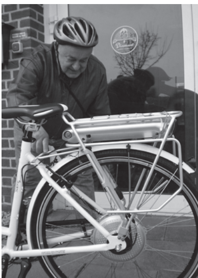
Motor an der Nabe, Akku unter dem Gepäckträger
