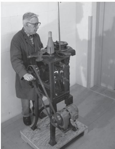
Stephan Ehrhardt beim Probelauf an der restaurierten Kleinrundstrickmaschine
