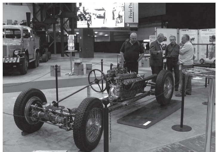
Das rekonstruierte Fahrgestell des Awtowelo 650
