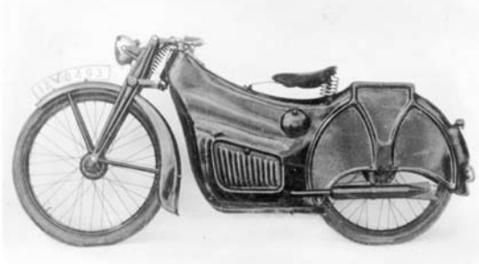
Prototyp eines Leichtmotorrades mit Vollverkleidung, 1941
